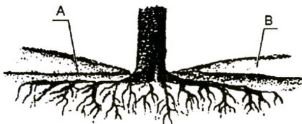
Rys. 4. Pień drzewa obsypany na wysokość 0,2 ÷ 0,5 m ze specjalnymi napowietrzającymi warstwami żwirowymi (wg [10])
