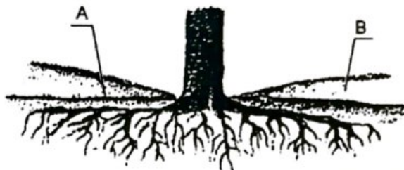
Rys. 4. Pień drzewa obsypany na wysokość 0,2 \div 0,5 m ze specjalnymi napowietrzającymi warstwami żwirowymi (wg [10])
